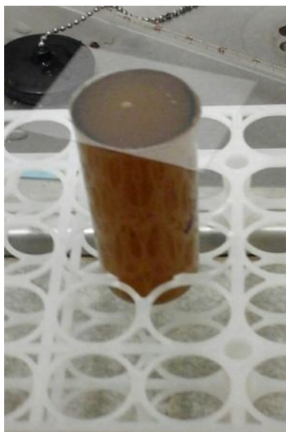
Joonis 8. Flotatsioonimeetodi töövahendid: katseklaas katteklasisiga ja mikroskoop (autori foto, 2016).
